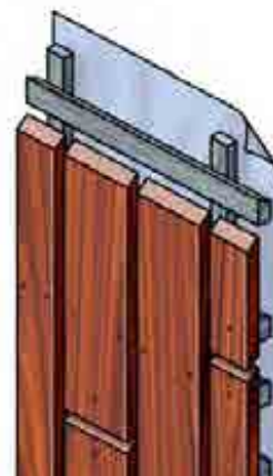
Tekening 4 Verticale open gevelbekleding op dubbel regelwerk.
